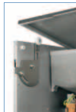
Fermeture impossible du distributeur avec le capot ouvert
